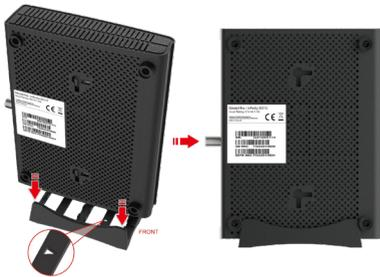
Rasten Sie die Unterseite des Kabelmodems in die Halterung ein und befestigen Sie es. Stellen Sie das Kabelmodem mit der Gerätehalterung senkrecht auf.
